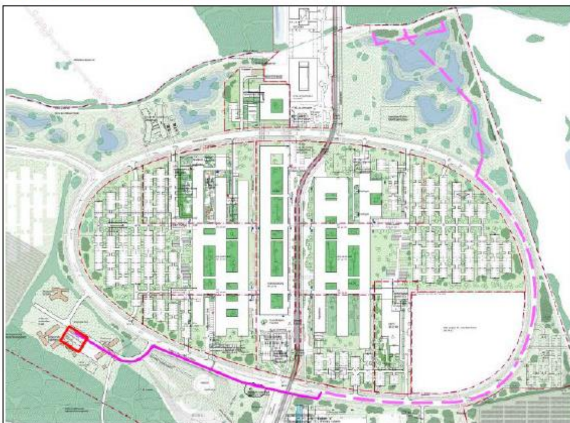
Figur 1. Oversigt over afvanding og rensning på Nyt Odense Universitetshospital (OUH). Den optrukne lilla linje er en trykledning fra OUH rensesanlæg til en afskærende regnvandsledning langs med ringvejen illustreret ved den stiplede lilla linje
