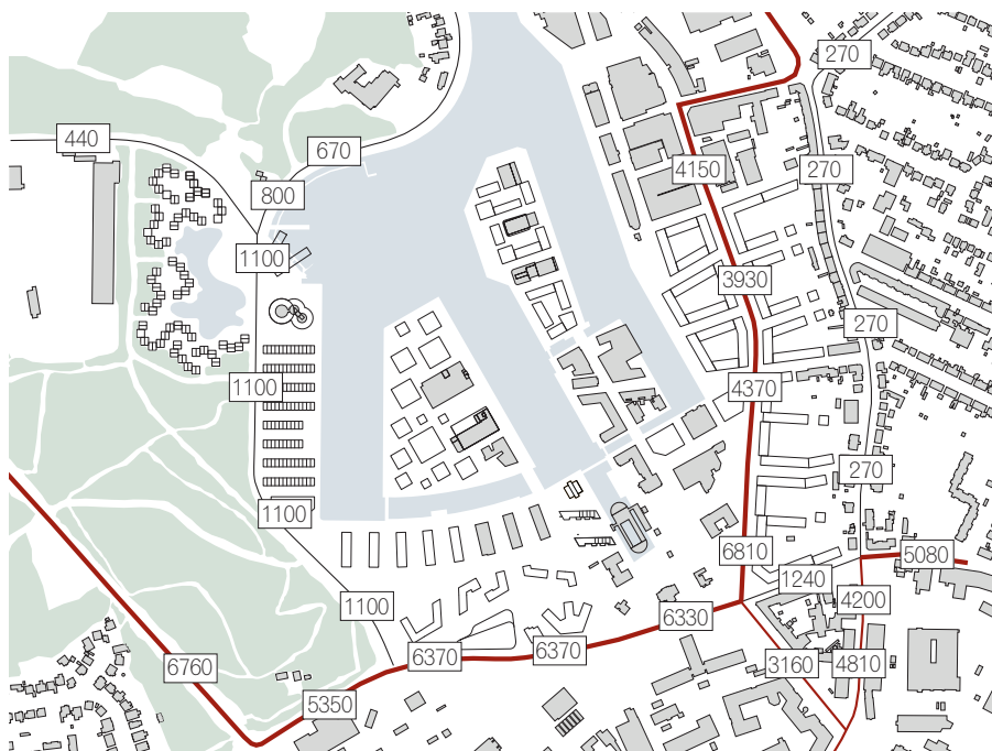
Trafiktal 2015 På kortet ovenfor ses den nuværende trafikale situation omkring havnen. Tallene på kortene angiver det gennemsnitlige antal biler pr. dag for et hverdagsdøgn (man-fre). (Strengtykkelsen forøges jo mere belastet strækningen er.)
