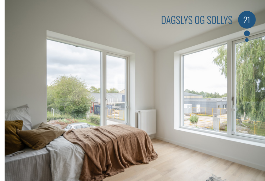
● Hjørnevinduer og vinduer til flere sider øger både lyset i rummet og solindfaldet. Boliger i Tingbjerg af Vandkunsten.
